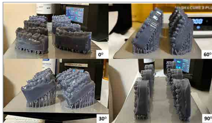
Figura 1 Modelele printate la 0°, 30°, 60° și 90°
