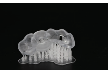
Fig. 7: Ghid printat 3D cu suporturi cu material Primeprint Guide.
