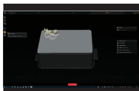
Fig. 6: Splint poziționat pe placa de fabricare Primeprint cu suporturi.
