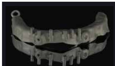
Fig.17 Suprastructură turnată din prototip din rășină turnată imprimată în 3D.
